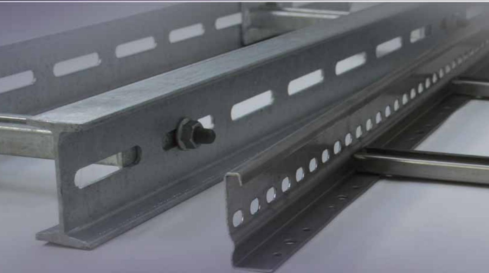
Das Steigetrassen-System lässt sich mittels Dübel ohne Zubehör direkt befestigen und weist zudem die gleichen Vorteile wie das Kabelleiter-System auf: hohe Tragfähigkeit durch die Holmform, stufen- und bohrlose Verschraubung der Wandanschlussteile dank durchgehender Seitenholmlochung, Schnellbefestigung der zu spannenden Elemente mittels Bügelschellen auf den C-Profil-/Winkleisensprossen.
